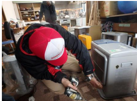
支給用のストーブの整備・点検
